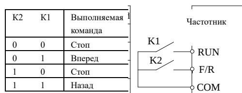
Рис. 6-14 Двухпроводной режим управления 2
