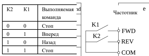
Рис.6-13 Двухпроводной режим управления 1
